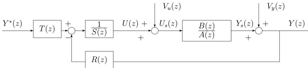
FIG. 5 – Boucle fermée avec correcteur RST
