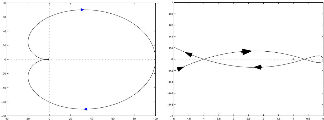
FIG. 9 – Diagramme de Nyquist de  $G(p)$  complet à gauche et zoomé à droite
