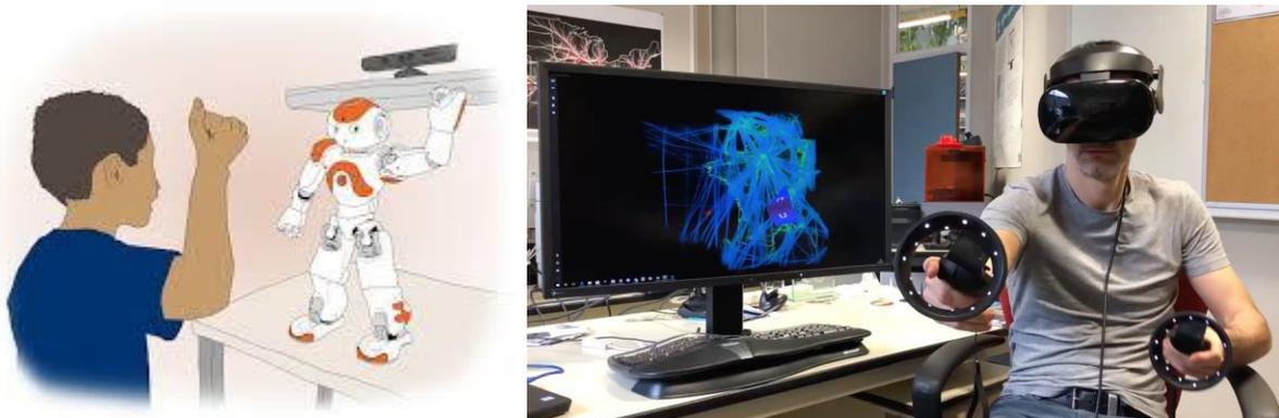
*Figure 1: (Gauche) Exemple schématique de la démonstration de téléopération NAO+Kinect du D5. (Droite) Exemple d'utilisation d'un casque de réalité virtuelle pour visualiser et manipuler des trajectoires de mouvements acquis par motion capture*
