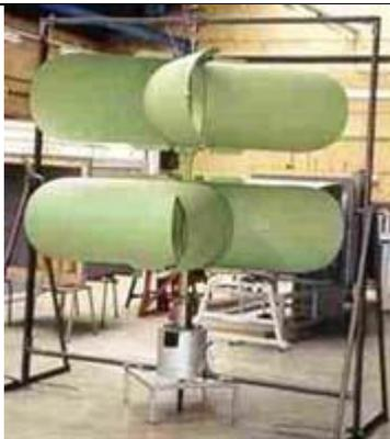
Afin d'améliorer le rendement, l'idée originale est de coupler sur le même axe plusieurs hélices superposées tournant en sens contraire afin de profiter au maximum des déviations de flux d'air.
