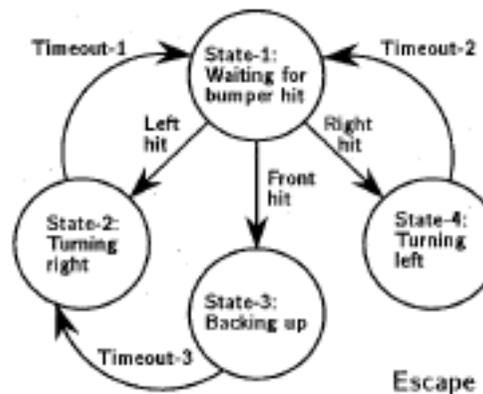
On constate : s'il y a une collision de face, on recule puis tourne à droite.
