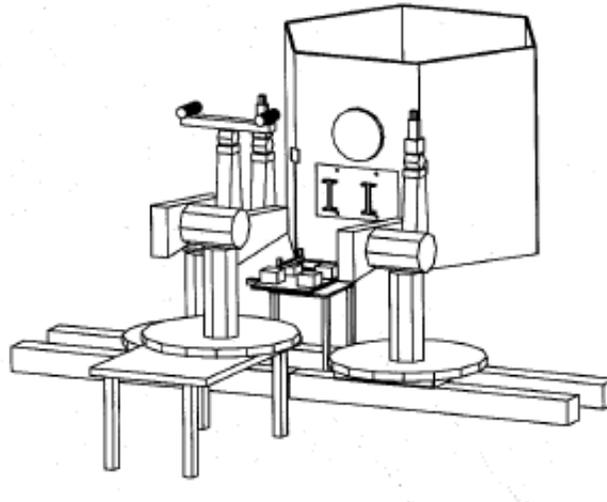
Fig. HANDEY (MIT) dans l'espace (manipulation par pince des satellites en orbite).
