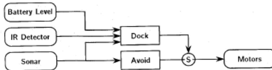
Diagramme à base de la réflexe du robot qui va en stand de charge
