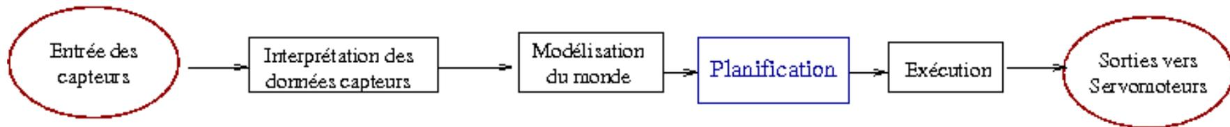
Fig. : les modules fonctionnels transforment les données capteurs en une série d'actions.
